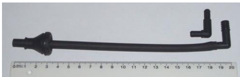
Batterieentlüftungsschlauch komplett. Einzelteil: Adapter 5,9mm (BMW-Originalteil)
