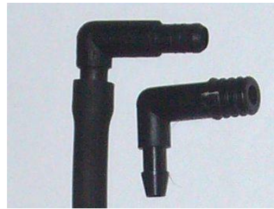
Batterieentlüftungsschlauch mit aufgestecktem 5,9-mm-Adapter (BMW), daneben 7,9-mm-Adapter (Toyota)
