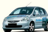
Fit FFV (Flexible Fuel Vehicle) – Dieses Fahrzeug ist derzeit in Brasilien erhältlich und kann mit Ethanol sowie Benzin in den Mischungsverhältnissen 20–100 % betrieben werden.
