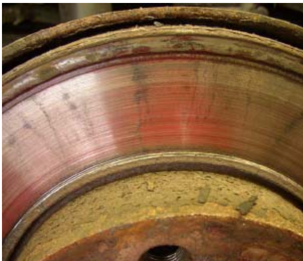
Bild 5: Gerade noch zulässige Bremsscheibenkorrosion (VW)
