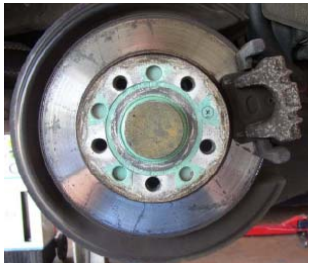
Bild 6: Fleckenbildung durch Ankleben von Bremsbelägen (VW)
