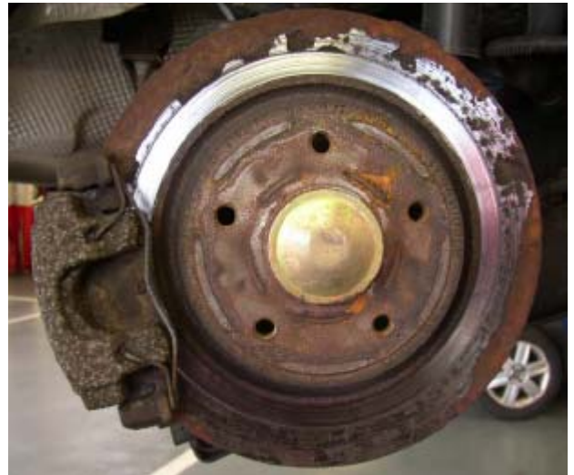
Bild 4: Unzulässig stark korrodierte Bremsscheibe (VW)
