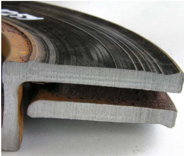
Bild 3: Bremsscheibe mit Riefen geschnitten (VW)
