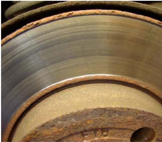
Bild 1: Aufoxidierte Ränder / Konturlinien (VW)
