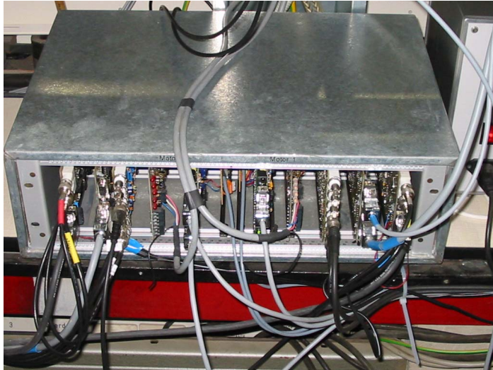
Abbildung 4-31 Hardware der Signalverarbeitung zur Ansteuerung des stufenlosen elektronischen Getriebes
