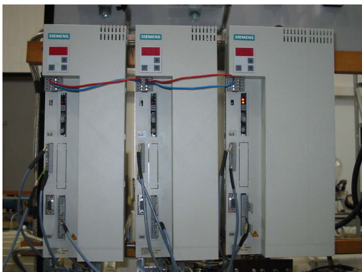
Abbildung 3-12 Zwischenkreisgekoppelte Umrichter 1-3
