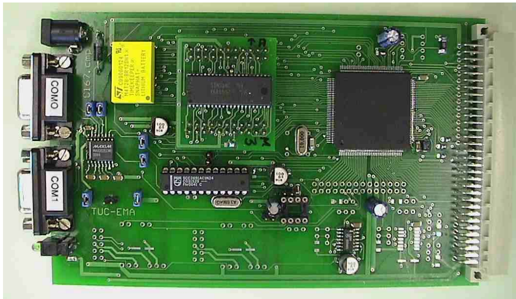
Abbildung 4-29 Controllerplatine zur Ansteuerung einer PSM
