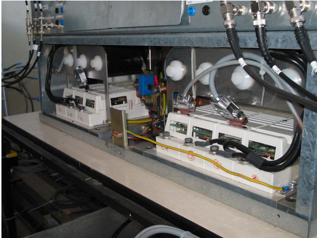
Abbildung 4-5 Wassergekühlter Doppelumrichter
